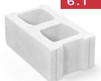
L'épaisseur équivalente d'un bloc de béton rend compte de sa teneur en béton. C'est une valeur dimensionnelle qui résulte d'un calcul dans lequel le pourcentage moyen de solides dans un bloc standard est multiplié par l'épaisseur efficace du bloc.
